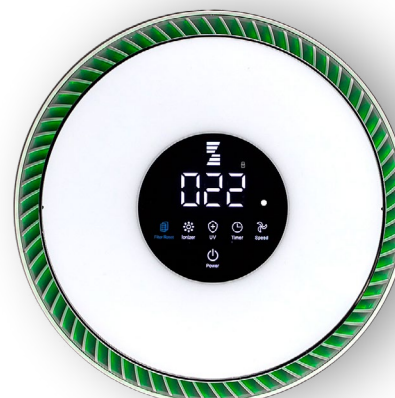
Količina PM 2,5 ( \mu\text{m}/\text{m}^3 ) 0-50 Kvalitet vazduha: veoma dobar Brzina: 1 Boja LED indikatora: zelena
