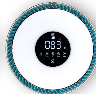
Količina PM 2,5 ( \mu\text{m}/\text{m}^3 ) 51-100 Kvalitet vazduha: prosečan Brzina: 2 Boja LED indikatora: plava
