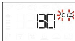
Roțiți selectorul pentru a seta temperatura cavitatei cuptorului.
